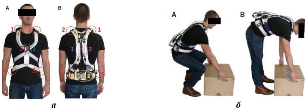
**Рисунок 1.6 – Исследование фигуры в динамике с помощью датчиков *IMU*: а – устройство для закрепления датчиков; б – рабочие движения**
