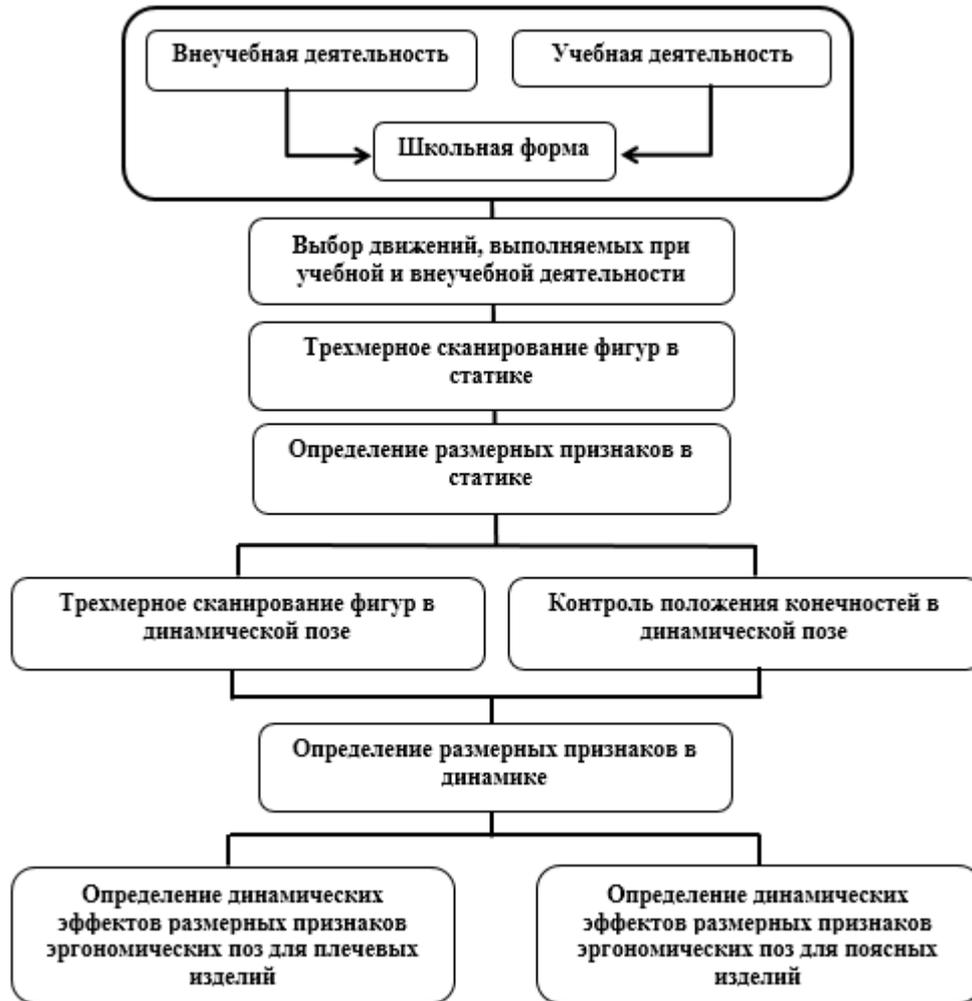
**Рисунок 3.15 – Обобщённая последовательность процесса определения динамических эффектов с помощью трехмерного сканирования**
