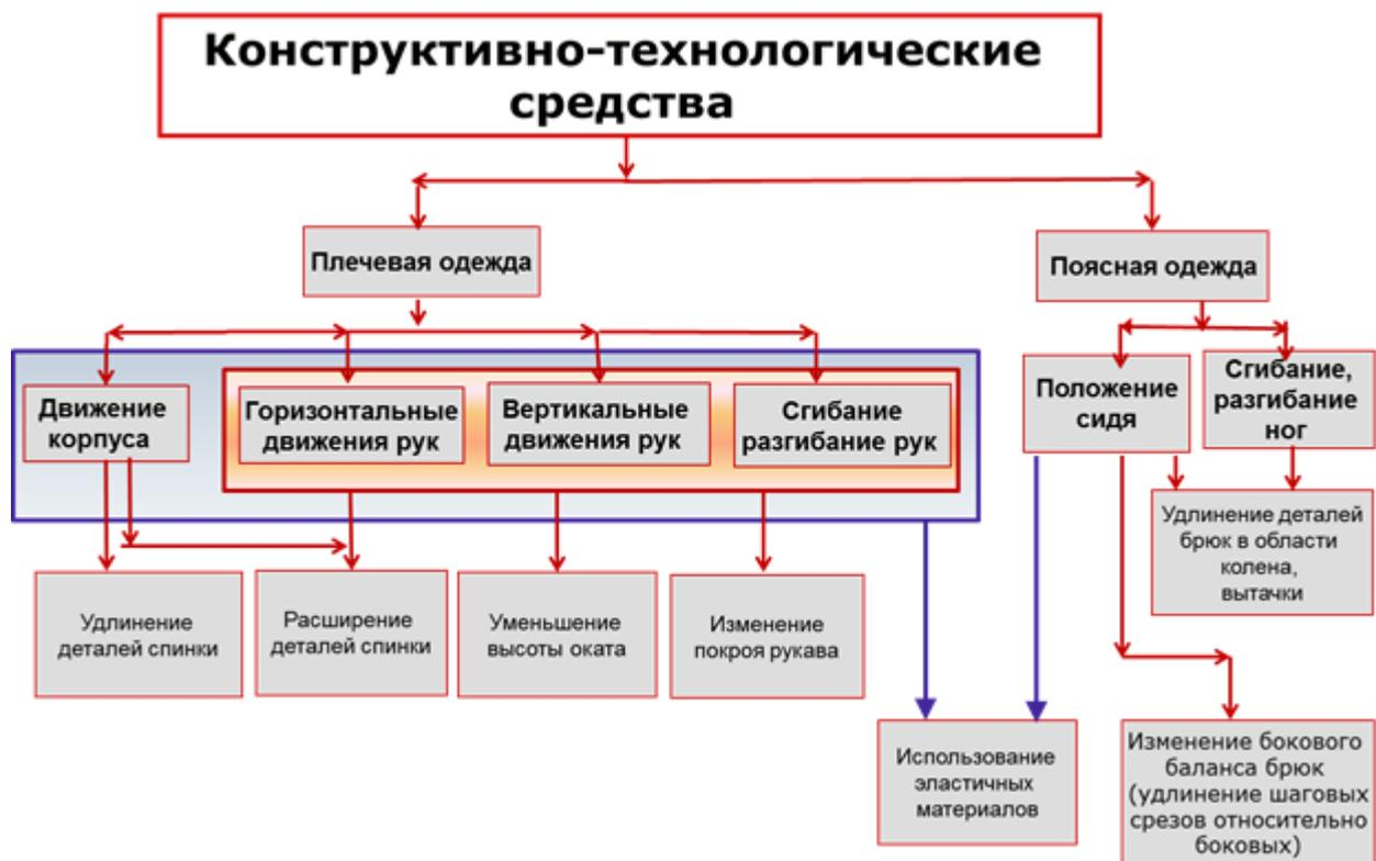
**Рисунок 1.16 – Классификация конструктивно – технологических средств обеспечения удобства проектируемой одежды в динамике**
